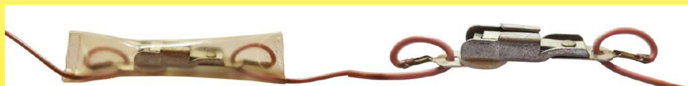
Limiteur de température de couverture chauffante à rupture lente Calor, étalonné à 80°C (vers 1960). On peut remarquer la boucle faite par les conducteurs électriques repassant par un trou dans chaque borne, afin d'éliminer les contraintes de traction sur le fil, et le manchon PVC étanche soudé sur les fils (Collection Ultimheat)
