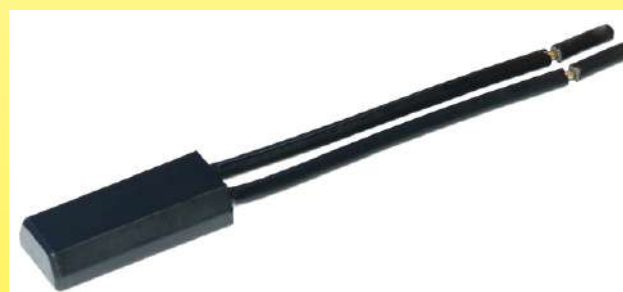
2019 Limiteur de température à rupture brusque pour couvertures chauffantes, dérivé du modèle Texas Instrument 7AM de 1966, utilisable en 230V, sous boîtier étanche plastique. Différentielle 5 à 8°C. Type V7AM. (Collection Ultimheat)
