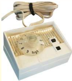
1970 ca réglage de puissance GEC (General Electric Company, Angleterre) sur couverture chauffante anglaise. La résistance anticipatrice est clairement visible au-dessus du bimétal et du contact à rupture lente (Collection Ultimheat).
